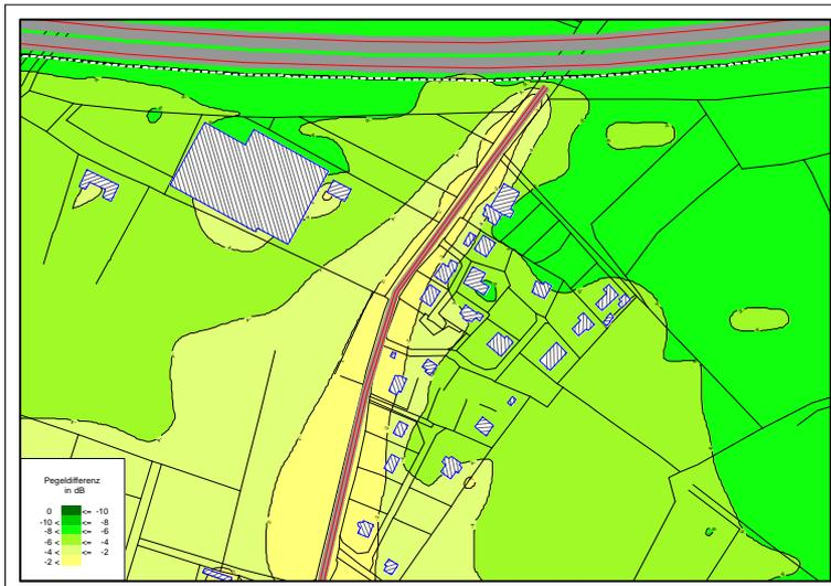
Abbildung 26: Differenzlärnkarte; Verbesserungspotential der Lärmsituation entlang der A2 durch Geschwindigkeitsbeschränkung und neuen Fahrbahnbelag
