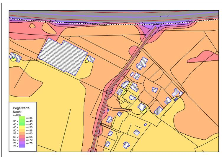
Abbildung 24: Lärmbelastung Südautobahn Knoten Ost → Laßnitzhöhe im Bereich der Unterführung der L 370; Geschwindigkeit PKW/LKW 130/80 km/h, Fahrbahnbelag Beton, Bestand 2015
